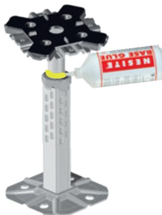
Per ottenere stabilità, allineamento, complanarità di tutti i pannelli ed un piano regolare è importante non sollecitare il pavimento durante la posa e per almeno 8 ore successive l'applicazione del collante (tempo minimo necessario per un sufficiente aggrappaggio).
