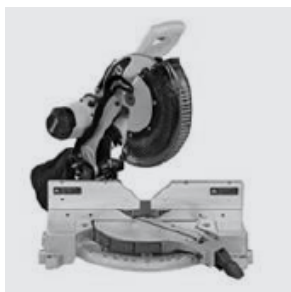
➤ TRONCATRICE PER IL TAGLIO DEGLI ELEMENTI DELLA STRUTTURA
